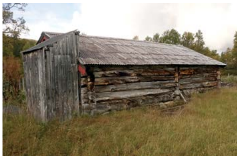
Bølgeblikkplater har reddet mange hus fra forfall når de gamle torvtakene ble utette.
