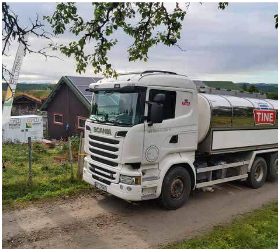
Mjølkebilen på veg for å tøma den solcelle-drivne gardstanken. I bakgrunnen står den tekniske konteinaren med batteri, elektronikk og styringsssystem (bilete: Erling Tingstad).
